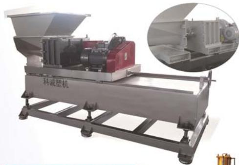
密炼单螺杆挤出生产线
