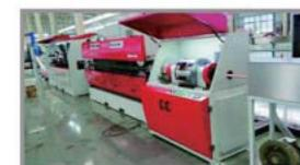
氩弧焊管轧纹生产线
