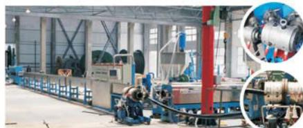
橡胶硫化挤出生产线
